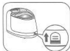
1. Coloque la cuba desmontable y fije el cierre. Si la cuba no está correctamente colocada, el botón de seguridad no cerrará fácilmente y el aparato no funcionará.
