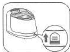
1. Placer la cuve démontable et fixer la fermeture. Si la cuve n'est pas placée correctement, le bouton de sécurité ne fermera pas facilement et l'appareil ne fonctionnera pas.
